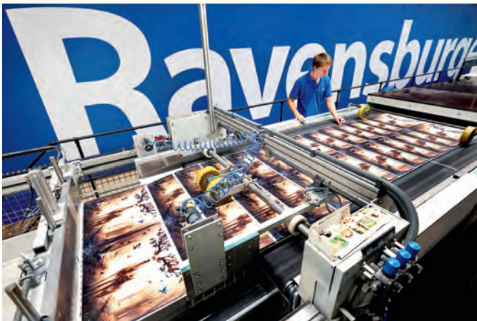
Die bedruckten Papierbögen sind zum Puzzeln zu dünn und werden deswegen auf eingeleimte Pappe gepresst.
